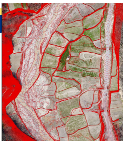
شکل ۴- منحنی میزان تولید شده حریم و بستر قسمتی از رودخانه خرمارود با تفکیک ارتفاعی ۲۵ سانتیمتر
